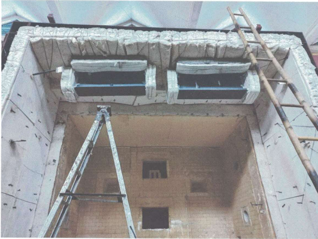
Ảnh G.14: Mẫu dầm ngấn được treo trên trần lò thử nghiệm
