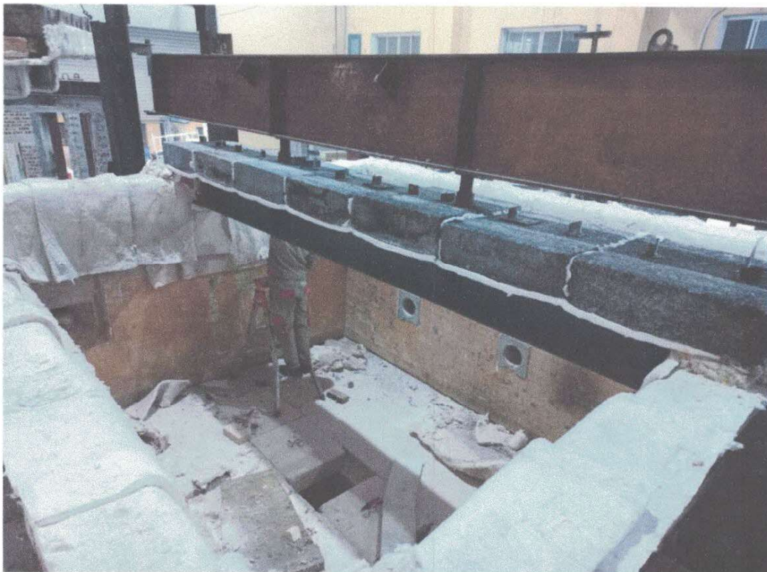
Ảnh G.18: Lắp dựng mẫu dầm có chất tải và khung gia tải vào lò
