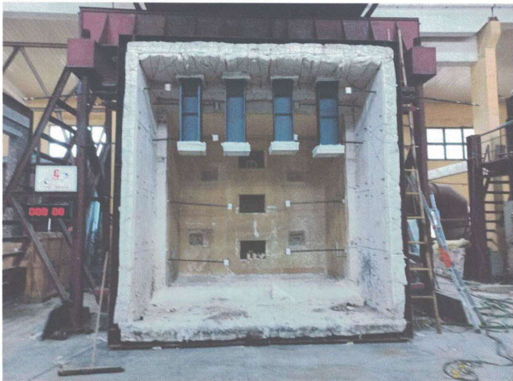
Ảnh G.13: Mẫu cột ngắn được treo trên trần lò thử nghiệm
