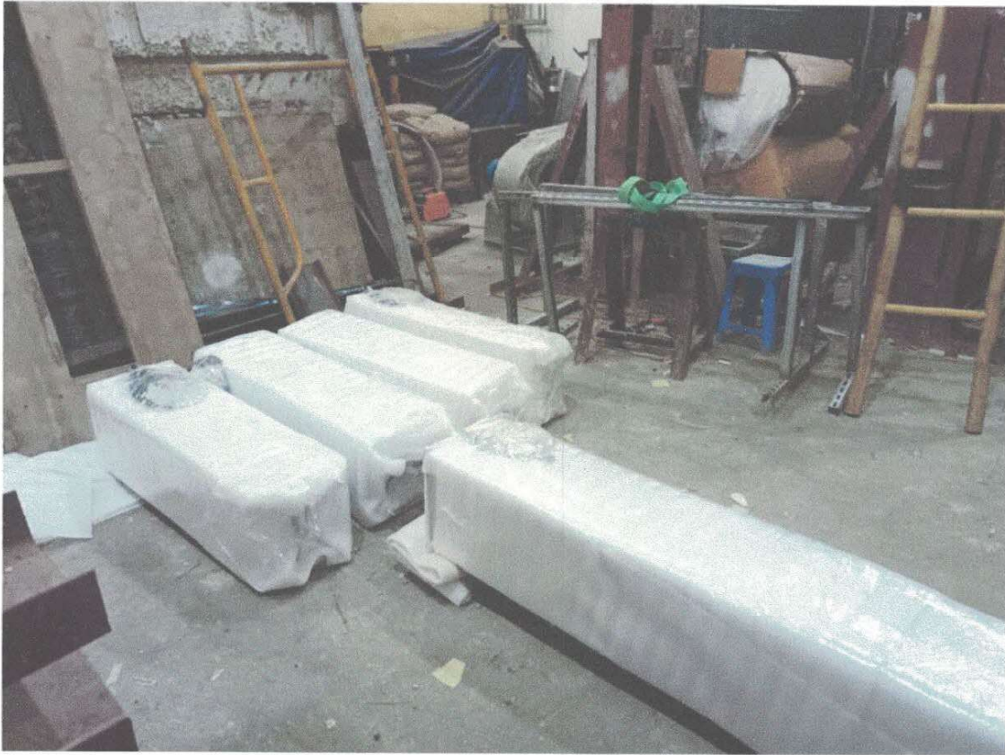
Ảnh G.10: Vận chuyển mẫu đã được bảo dưỡng tới phòng thử nghiệm
