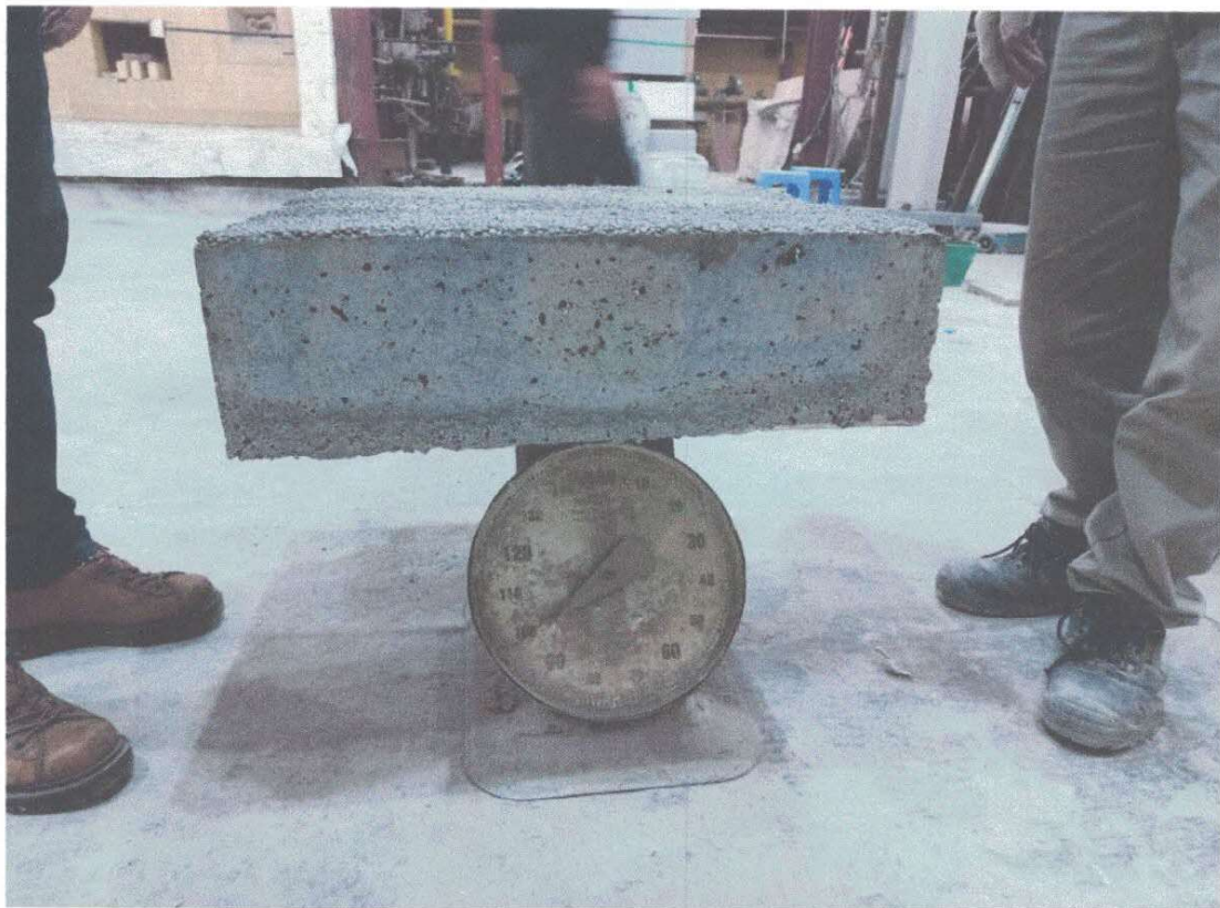
Ảnh G.22: Tấm sàn lắp ghép trên dầm có chất tải
