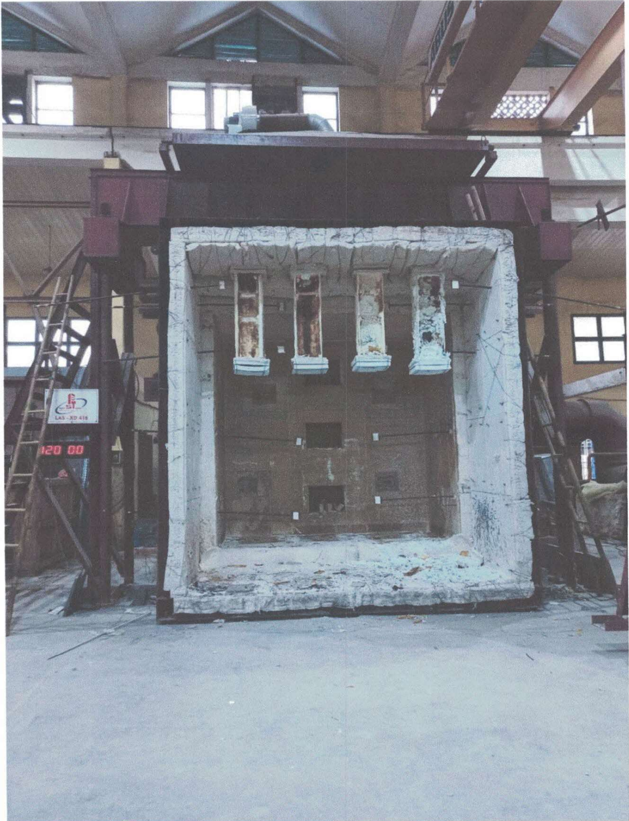
Ảnh G.25: Bề mặt mẫu cột ngắn có chất tải sau khi thử nghiệm
