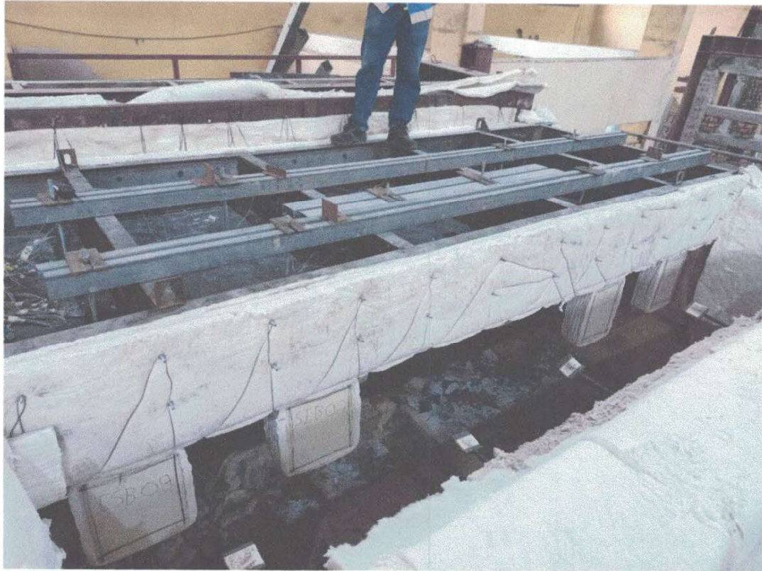
Ảnh G.17: Các dầm treo trên trần lò thử nghiệm
