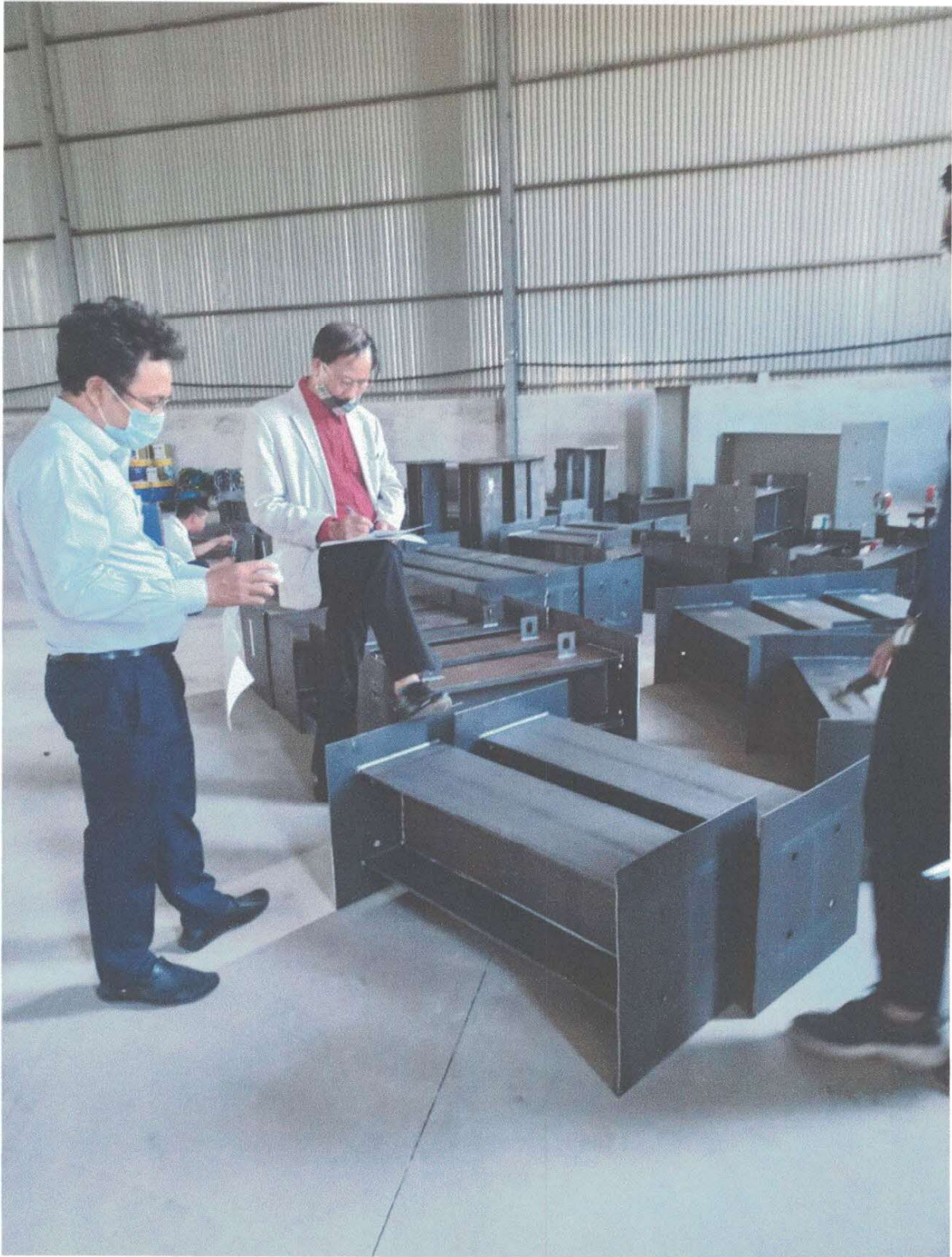
Ảnh G.1: Nghiệm thu mẫu thử trước khi sơn
