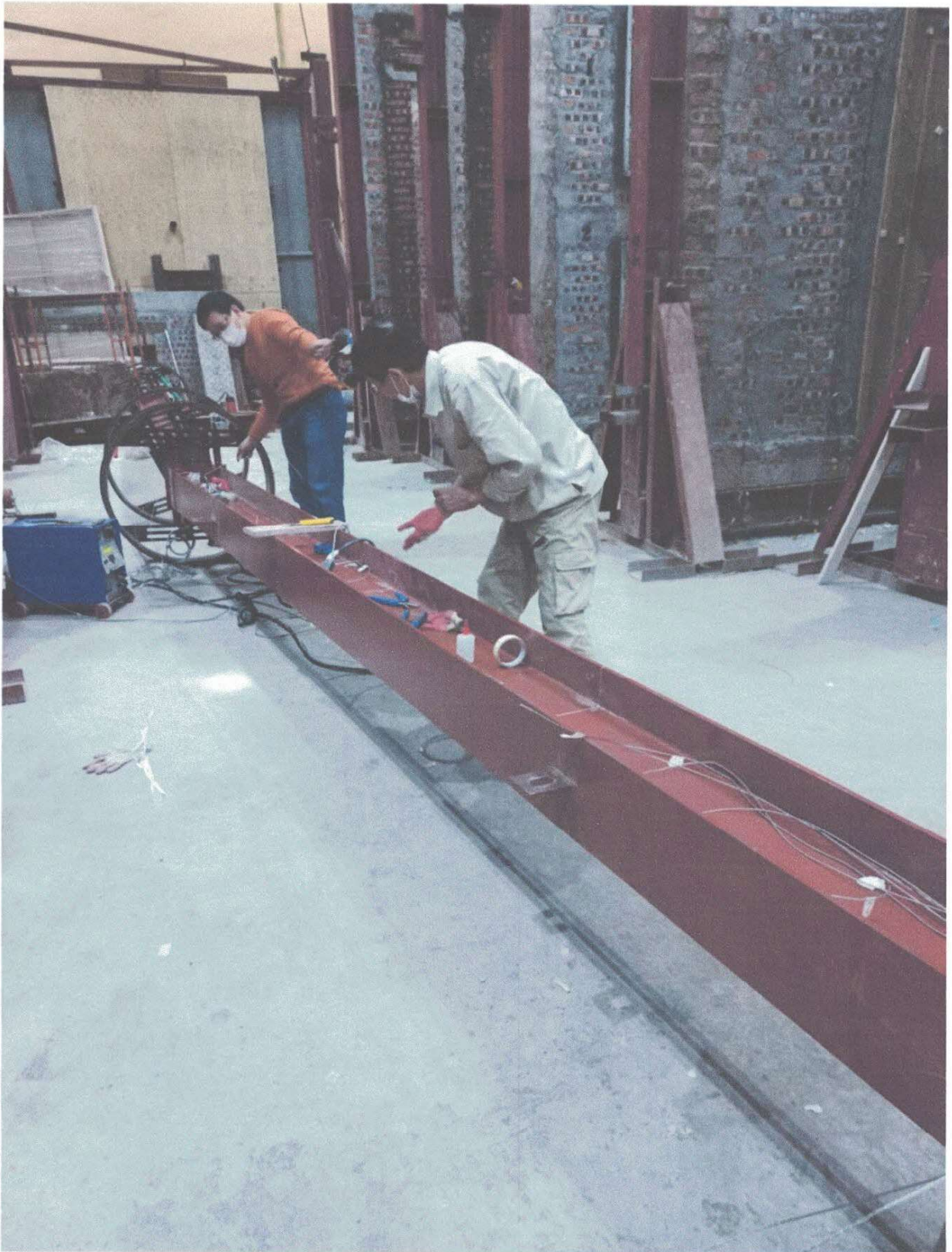
Ảnh G.4: Công tác gắn đầu đo nhiệt trên mẫu
