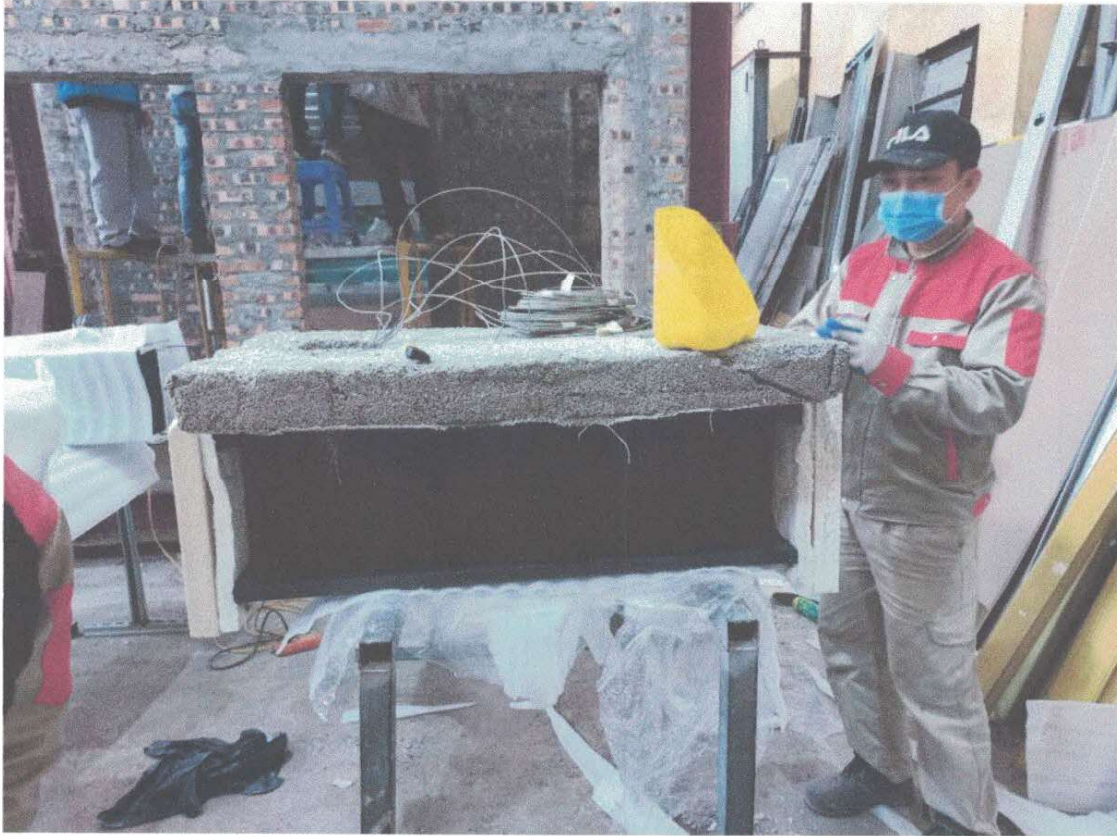
Ảnh G.12: Lắp tấm cách nhiệt trên mẫu
