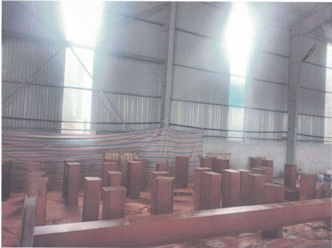
Ảnh G.5: Các mẫu thử đã được sơn lót
