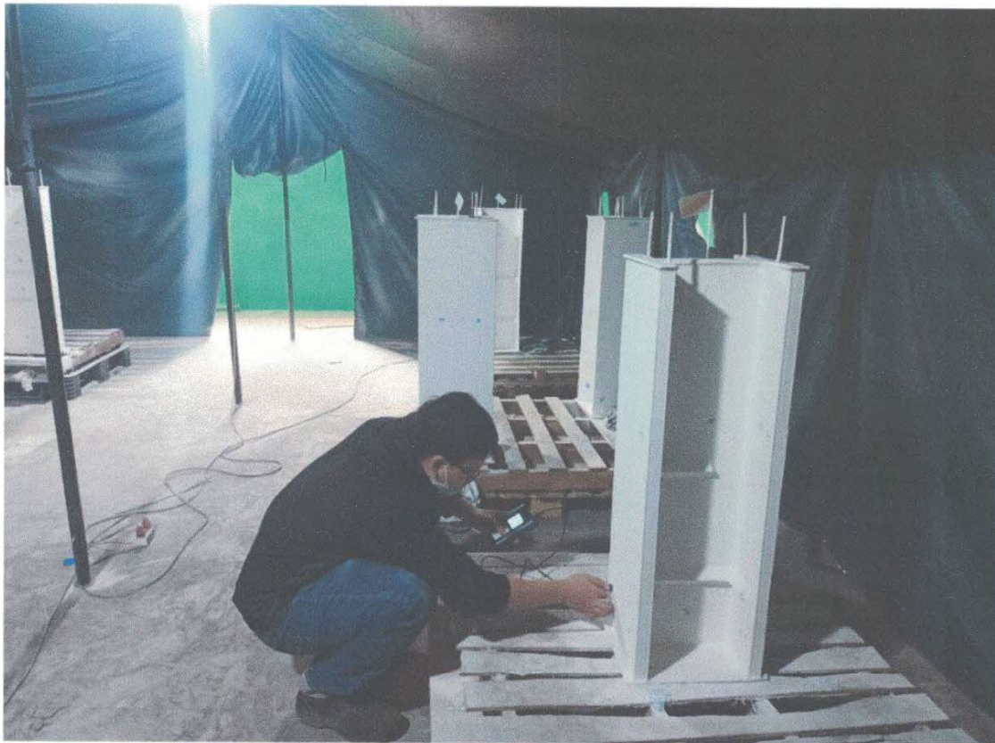
Ảnh G.9: Đo, kiểm tra chiều dày sơn chống cháy
