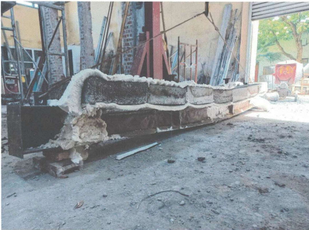
Ảnh G.24: Bề mặt mẫu đầm có chất tải sau khi thử nghiệm
